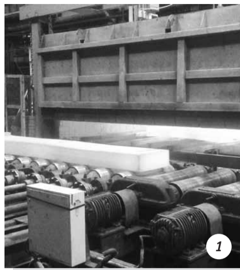
Пробный нагрев слитков на печи с шагающим подом
