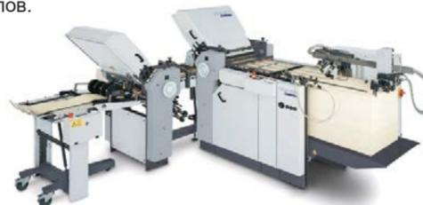
➤ **скоростную фальце-склеивающую машину (BOBST, Швейцария)**, которая позволяет производить различные типы коробок из широкого диапазона материалов при скорости до 450 метров в минуту.
