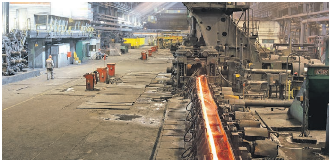
↑ Новые профили катают на стане «450»
